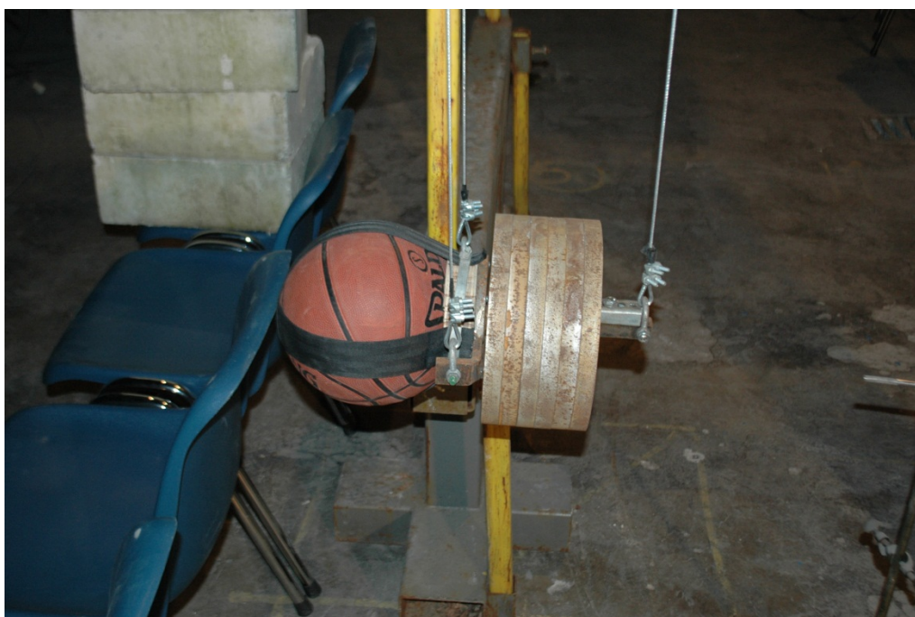
Foto 5: Horizontale impacttest in uitvoering
